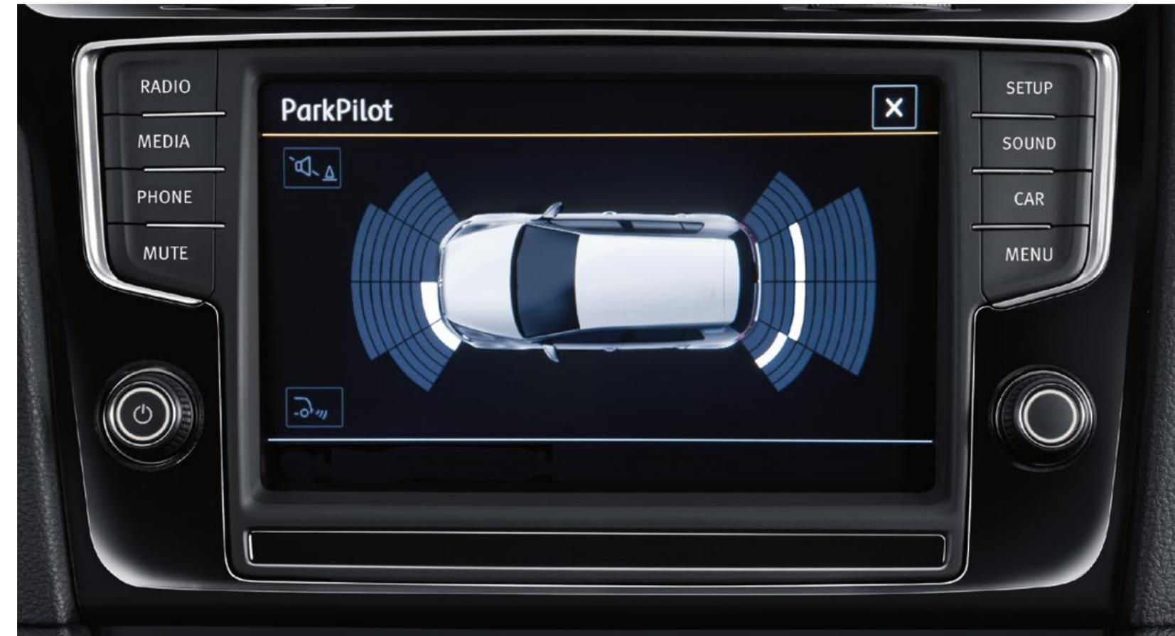
El **sistema de radio Composition Media**, disponible para todas las versiones, posee una pantalla TFT en color de 14,7 cm (5,8 pulgadas), pantalla táctil con sensores de aproximación, lector de CD compatible con los formatos mp3 y WMA con ocho altavoces, 4 x 20 W de potencia, incorpora además lector de tarjetas SD, toma Aux-In y conexión Bluetooth para teléfonos móviles.
