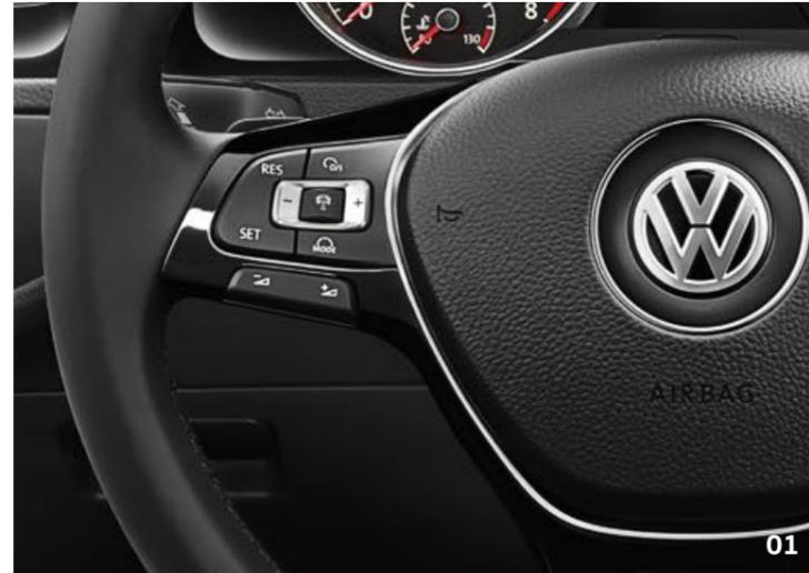
**01 Cruise Control:** A partir de 30 km/h, el Control de velocidad crucero mantiene constante la velocidad que hayas seleccionado, mejorando considerablemente el confort sobre todo en los viajes largos. Además, el limitador de velocidad integrado permite ajustar un límite de velocidad máximo, de modo que no se supere la limitación de velocidad ajustada incluso al aumentar la presión sobre el pedal del acelerador.
